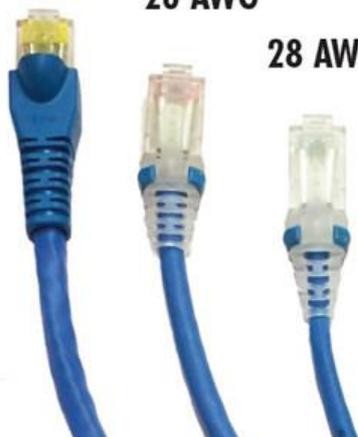
La construcción de este Latiguillo con cobre de menos sección (**AWG-28**) ofrece un radio de curvatura significativamente más pequeño, mejorando y facilitando con ello su colocación e instalación, proporcionando un ahorro de espacio en los bastidores o Rack's y facilitando así su manipulación, ampliación o cambios en espacios reducidos.
